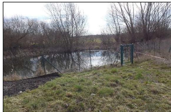
Permanentes Kleingewässer, umzäunt, als Löschwasserentnahmestelle in Nutzung
